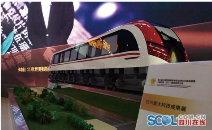
与传统轮轨列车不同,磁浮列车采用电磁悬浮加直线电机驱动。在我国,近年来磁浮列车逐渐变为现实并应用于城市公交,上海、长沙、北京等地已有磁浮列车专线。这列磁浮列车何以能作为四川科技成果进驻展区?
