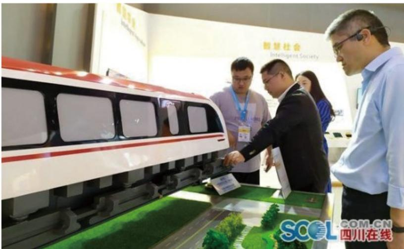
“目前为止,投入运营中的中低速磁浮列车采用的悬浮架为井字型,而我们的悬浮架是二代产品,为工字型结构。”刘洋介绍,在理想情况下,预计这种磁浮列车结构强度高出30%,重量却减轻20%,运行更稳定。
